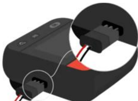
Fig. 7 Tilkobling av elektrodertil enheten
